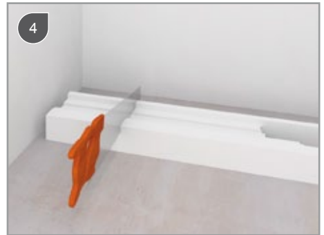
Lõika polüstüreenist installatsiooniplokk otsestest parajaks
