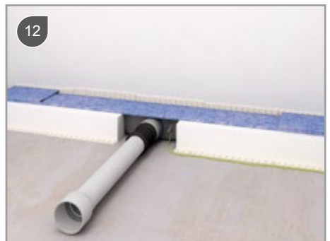
Suurenda äravoolutoru Ø50mm-le vähemalt 1 m trapist või enne põlve paigaldamist
